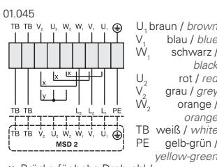
x Brücke für hohe Drehzahl / bridge for high speed
